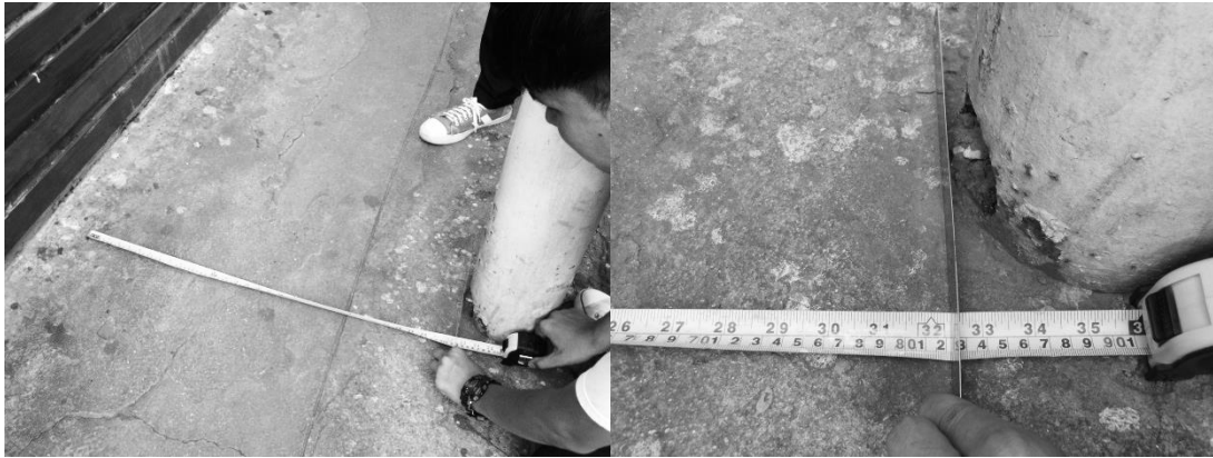
ภาพที่ ๙ แสดงระยะของโครงสร้างป้ายหยุดรถแท็กซี่บริเวณที่ทางเท้าแคบ
